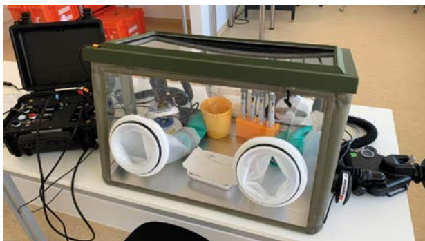
Boîte à gants avec unité de commande technique (à gauche) et unité de soufflage (à droite). Photo : S. Weiß
