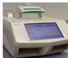
Transkription der RNA in cDNA (RT) und Amplifizierung von mindestens zwei SARS-CoV-2-spezifischen Genfragmenten im Thermocycler
