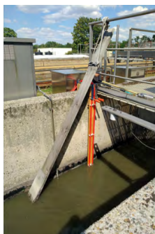
Entnahme von Abwasser am Zulauf der Kläranlage
