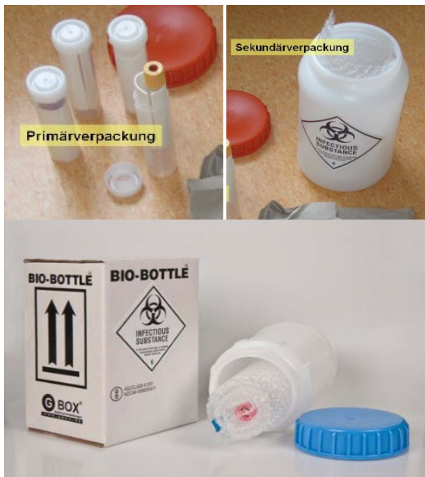
Abbildung 4: Probennahmefläße. Oben schematischer Aufbau der Verpackung, darunter Beispiele für Primär-, Sekundär- und Tertiärverpackung (gemäß ADR: starre Außenverpackung).
